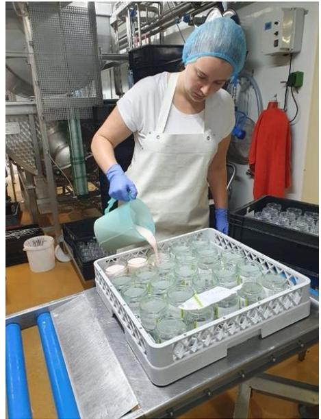
Fertigen Erdbeeryoghurt abfüllen; links in 500ml Kunststoffbehälter mit der Abfüllmaschine, rechts in 200g Gläser mit Litermaß.
